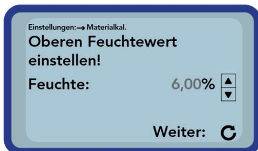
Anschließend wird die prozentuale Feuchte des oberen Feuchtwertes mit den Tasten „Hoch“ und „Runter“ eingestellt und anschließend mit der Taste „Messen“ bestätigt.
