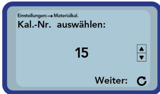
Zu Beginn der Kalibrierung muss der zu überschreibende Kalibrierspeicher (01 – 15) mit den Tasten „Hoch“ und „Runter“ eingestellt werden. Mit der Taste „Messen“ wird die Einstellung übernommen.
