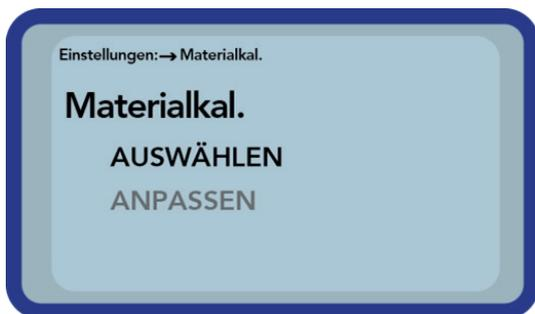
Nach Auswahl des Menüpunktes „Materialkal.“ wählen Sie zwischen „AUSWÄHLEN“, um eine der 15 Kalibrierungen einzustellen, oder „ANPASSEN“, um eine neue Kalibrierung auf einem der 15 Kalibrierspeicher vorzunehmen.
